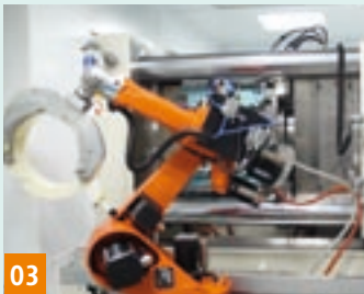
03 Im Reinraum: Entnahme, Abstapeln und Verpacken in einer doppelten Folienverpackung per Knickarm-Roboter.
