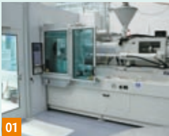
01 Graue Zone: Spritzgießmaschine im „Rooming-in“ – nur die Schließeinheit befindet sich im Reinraum.
