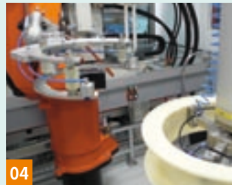
04 Nach Kundenanforderung: Berührungsfreies Stapeln in doppelter Folienverpackung.
